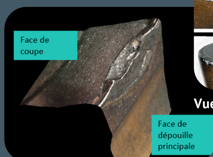
Vue 3D d'une arête de coupe usée
